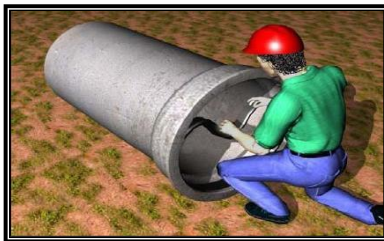
Figura 2- Colocação do anel de borracha
